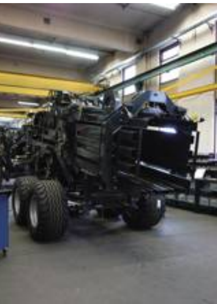
■ La camera delle big baler Kuhn è lunga 3 metri.
