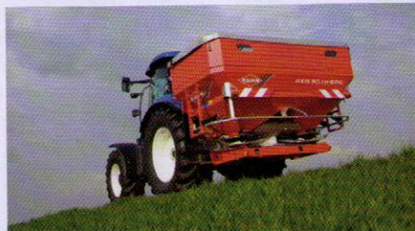
■ Il sistema Electronic Mass Control misura e regola costantemente lo scorrimento del concime su ciascun disco.
