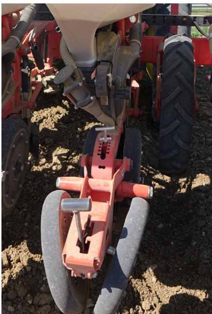
Con due leve posteriori si regolano facilmente la profondità di lavoro e la chiusura del solco
