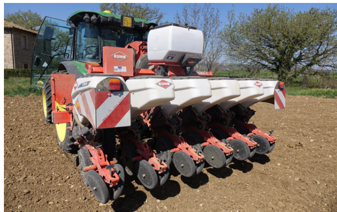
Paci ha optato per una Kosma M portata, per avere più maneggevolezza, e a telaio fisso di 3 m, così da poterla usare comodamente anche in fase di trasporto
