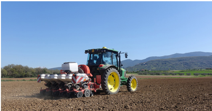
Con Kosma M per la semina del girasole Paci lavora a circa 7 km/h, per un'autonomia di 4 ettari/ora (con 110-115 kg di microgranulare)
