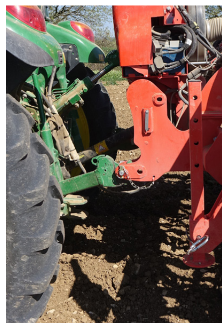
Per essere il più vicino possibile al trattore il telaio Kosma presenta due possibilità di attacco
