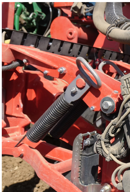
Per ogni unità di semina ci sono due molle di regolazione della pressione al suolo
