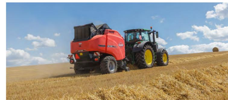
Le rotopresse VB 7100 sono dotate di un portellone con il funzionamento **più veloce del mercato: in soli 4 secondi la balla viene espulsa e il portellone si richiude.**
