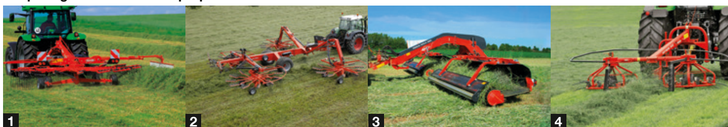
1. Monorotore - 2. Semi-portati a 4 rotori - 3. Andanatori a tappeto - 4. Combinazione andanatore-voltafieno
