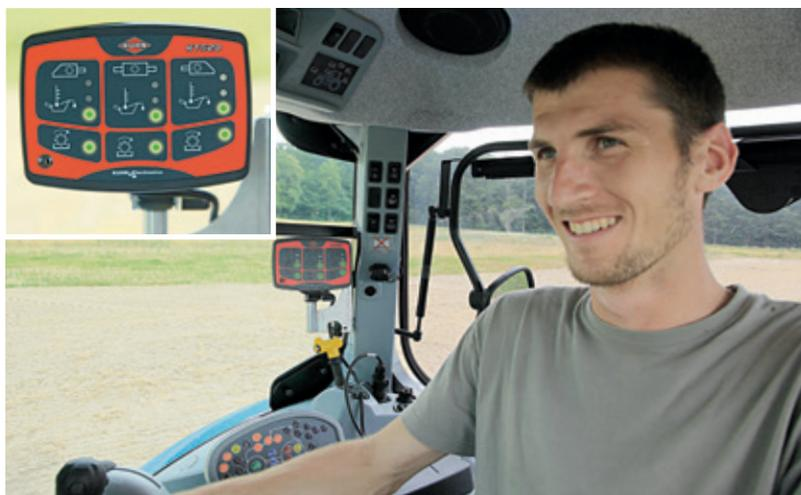
Per aiutare l'operatore a rispettare la tabella di marcia senza alcuna preoccupazione gli erpici rotanti pieghevoli HR 1040 R sono stati dotati della centralina KTS 20. Installata in cabina, monitora costantemente la temperatura e la rotazione delle tre scatole cambio della macchina. Non appena un limitatore di coppia scatta o la temperatura dell'olio si innalza eccessivamente, l'operatore può immediatamente intervenire, per evitare guasti o danneggiamenti.
