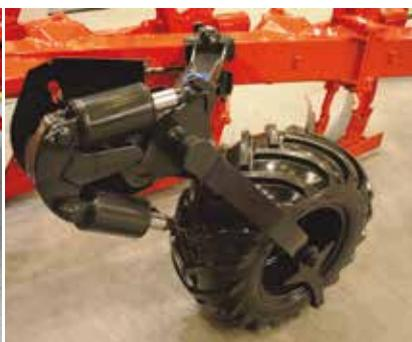
**RUOTA PIVOT AMMORTIZZATRICE CON REGOLAZIONE IDRALICA HD TRONIC**
