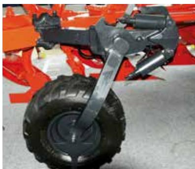
**RUOTA PIVOT CON REGOLAZIONE IDRAULICA**
