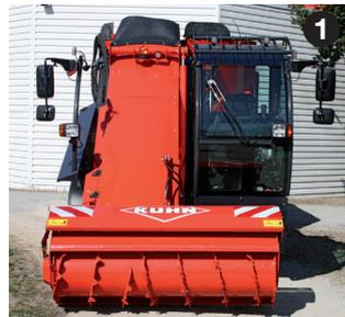
Il convogliatore di caricamento presenta una concezione tutta nuova! Innanzitutto nel trascinamento. Il tappeto è trascinato da un motore idraulico situato sopra il convogliatore (2). Ciò consente di tirare il tappeto così da favorire il centraggio del nastro. Sempre riguardo al centraggio, il tappeto è munito di una lamella che passa in una gola a livello dei rulli di trascinamento. In questo modo il nastro è sempre centrato in mezzo al convogliatore evitando l'usura laterale.
