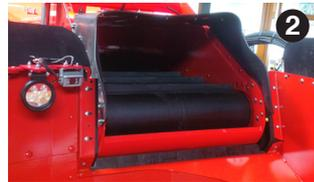
Per aumentare la portata di caricamento di questa nuova gamma di carri unifeed semoventi, il convogliatore è stato allargato da 650 a 800 mm (3). Il flusso di foraggio transita così più rapidamente tra la fresa e la cassa.
