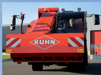
Ampio tappeto di carico (650 mm) per la massima capacità
