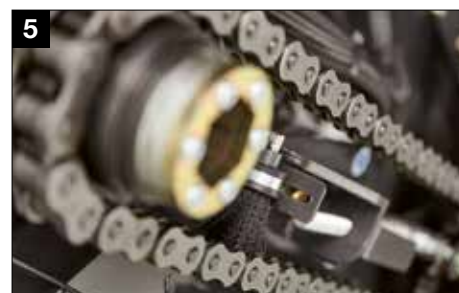
Spazzole di lubrificazione ampie e robuste sulla catena assicurano una lubrificazione perfetta
