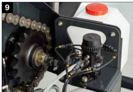
Sistema di lubrificazione catene in continuo Beka max
