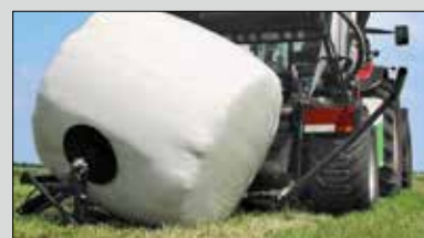
Ribaltatore balla, per scaricare la balla sulla faccia piana
