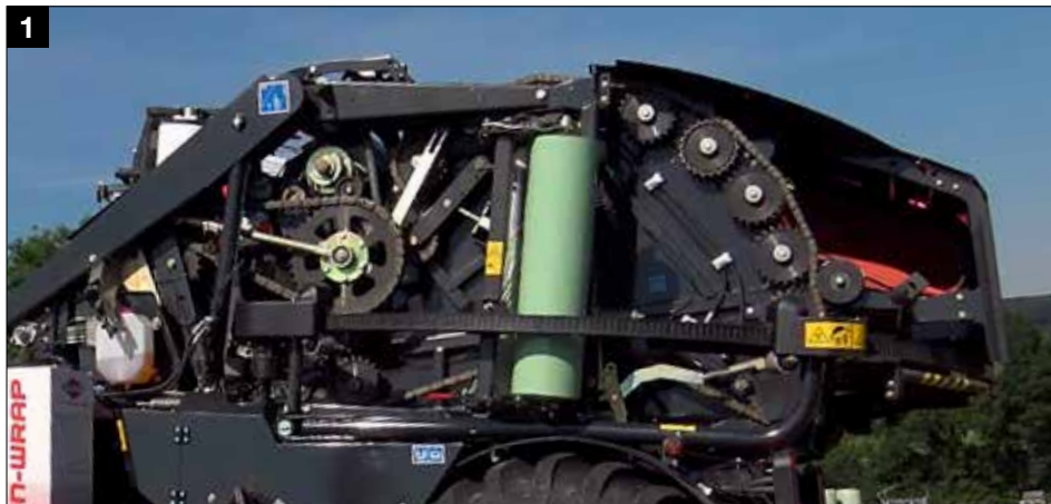
1 Trasmissione robusta tramite catene di alta qualità IWIS
