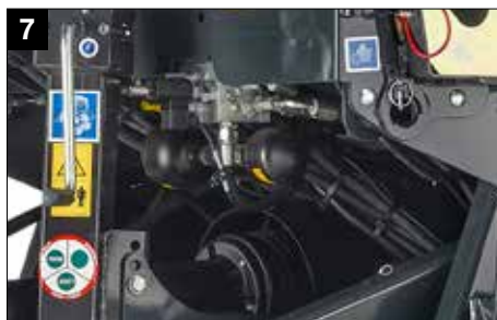
Valvola proporzionale per il controllo della densità in cabina di serie
