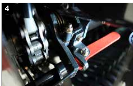
4 Disinnesto meccanico del rotore
