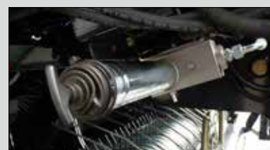
sistema di ingrassaggio automatico Beka Max
