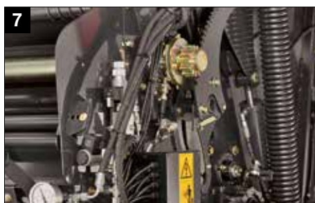
7 Valvola proporzionale per il controllo della densità in cabina
