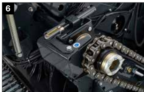
Disinnesto idraulico del rotore di serie
