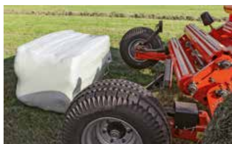
La ridotta altezza della piattaforma permette di scaricare dolcemente la palla prevenendo il danneggiamento della pellicola
