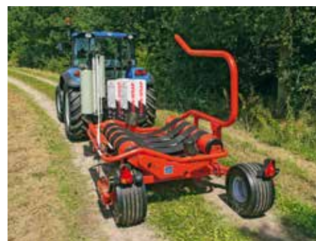
Larghezza di trasporto limitata grazie alla posizione regolabile delle ruote
