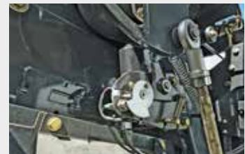
Sistema di legatura elettrico
