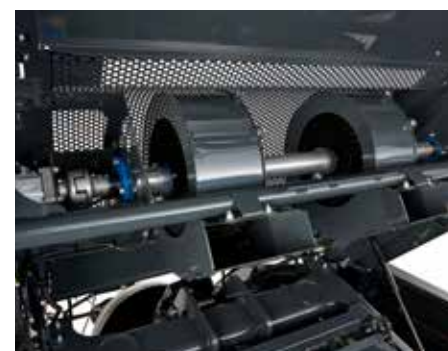
6. Turbine per la pulizia dell'annodatore
